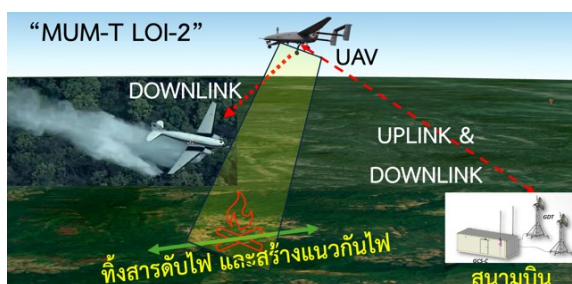
ภาพที่ ๗ ภาพจำลอง MUM-T LOI-2 ระหว่างเครื่องบิน BT-67 กับ UAV ในการกึ่งการควบคุมไฟฟ้า
