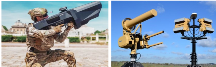
ภาพที่ ๔ ระบบต่อต้านอากาศยานไร้คนขับ สำหรับการยับยั้ง (Soft Kill)
