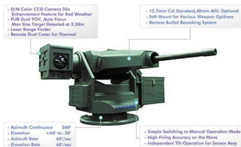
ภาพที่ ๑๘ ปืนกลตั้งอยู่กับที่ (Sentry Machine Gun) รุ่น Samsung SGR-A1
